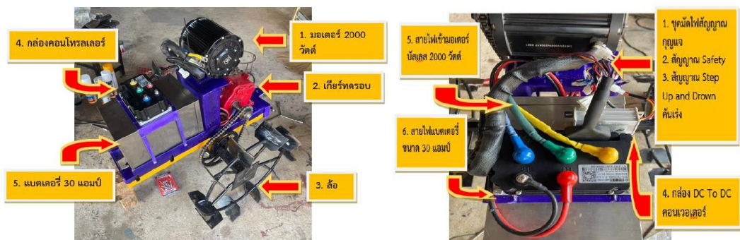
รูปที่ 2 การออกแบบ และจัดวางอุปกรณ์ต่าง ๆ บนตัวรถไถพรวนดินเดินตามขนาดเล็กล้างงานไฟฟ้า
