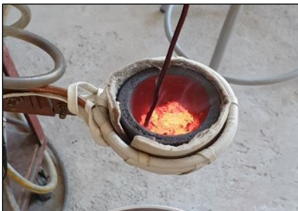
รูปที่ 14 ภาพจริงการทดลองเครื่องหลอมโลหะโดยใช้หลักการให้ความร้อนแบบเหนี่ยวนำ
