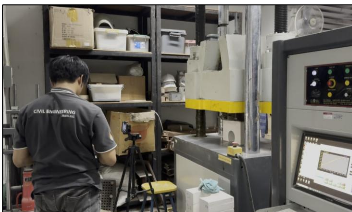
รูปที่ 4 การทดสอบกำลังรับน้ำหนักด้วยเครื่องทดสอบ UTM
