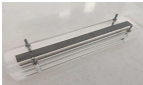
รูปที่ 1 แม่เหล็กนีโอไดเมียมที่ติดตั้งลงบนผ่านอะคริลิก
