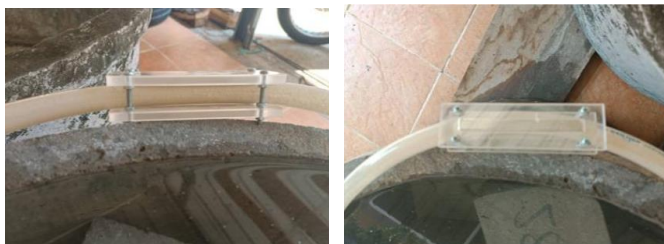
รูปที่ 2 แม่เหล็กนีโอไดเมียมที่ติดตั้งลงบนผ่านอะคริลิก
