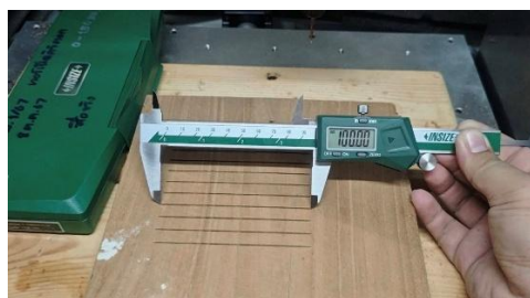
รูปที่12 การตรวจสอบความแม่นยำด้วยการใช้เวอร์เนียคาลิเปอร์ตรวจสอบความยาวในแนวแกน x ความยาว 100 มิลลิเมตร ผลการตรวจสอบค่าที่ได้ 100.00 มิลลิเมตร
