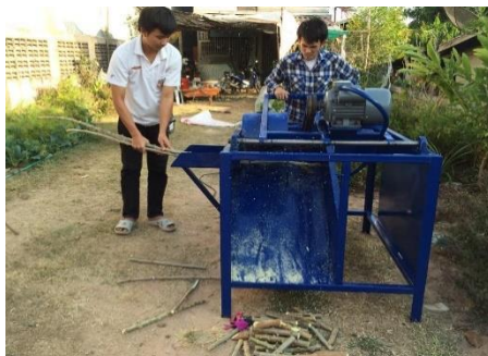
ภาพที่ 2 เครื่องตัดท่อนพันธุ์มันสำปะหลัง
