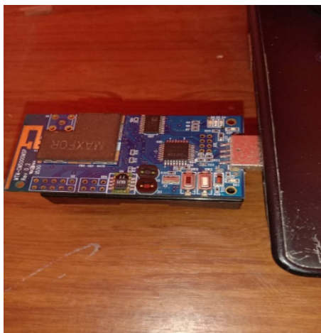
ภาพที่ 2 โมดูล Tmote Sky (Server) ที่เชื่อมต่อกับเครื่องคอมพิวเตอร์
