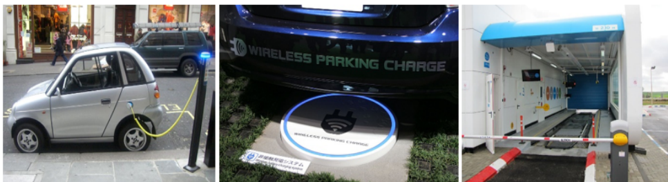
ภาพที่ 1 สถานีอัดประจุแบบมีสาย สถานีอัดประจุแบบไร้สาย และ สถานีสับเปลี่ยนแบตเตอรี่
