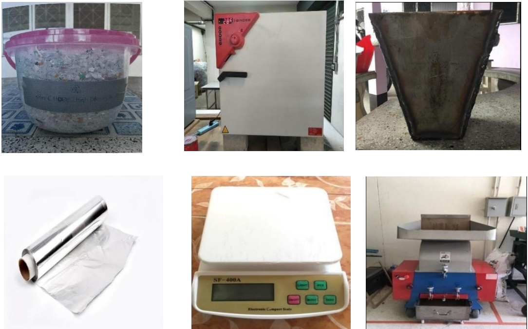
Figure 1 เครื่องมือที่ใช้ในการทดลอง (ก) วัสดุพลาสติก (ข) เครื่องเป่าลมร้อน (ค) แม่พิมพ์แบบ (ง) Aluminum Foil (จ) ตาชั่งดิจิตอล (ฉ) เครื่องบดตัดพลาสติก
