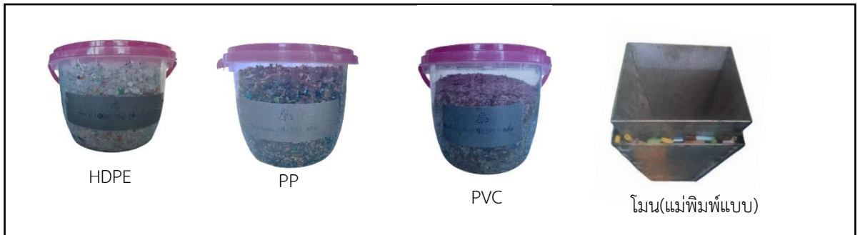
Figure 3 พลาสติกประเภท HDPE, PP และ PVC บด พร้อมขึ้นรูป และ แม่พิมพ์แบบที่ใส่พลาสติก พร้อมเข้าเครื่องอบลมร้อน
