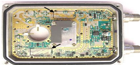
ภาพที่ 1 ตัวอย่างวงจรกรองความถี่แถบผ่านบนโครงสร้างระนาบ (ตามลูกศรชี้)
