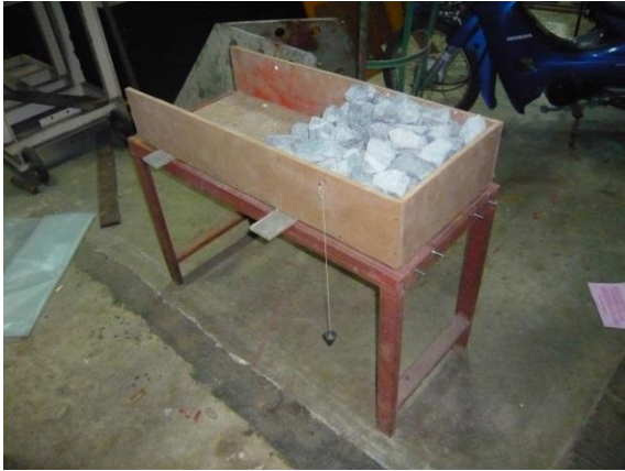
(a) รางปรับความลาดชันขณะใช้งาน
