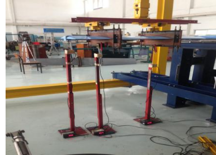
รูปที่ 11 ปีกติดตั้งบนชุดทดสอบวัสดุ (MTS)
