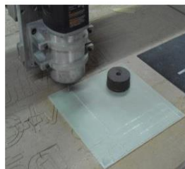
รูปที่ 6 ตัดชิ้นงาน
