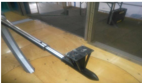
รูปที่ 8 การติดตั้งเพื่อยึดกับเครื่องมือวัดแรงเพื่อหาค่าความคลาดเคลื่อนที่เกิดขึ้นจากแท่นยึด
