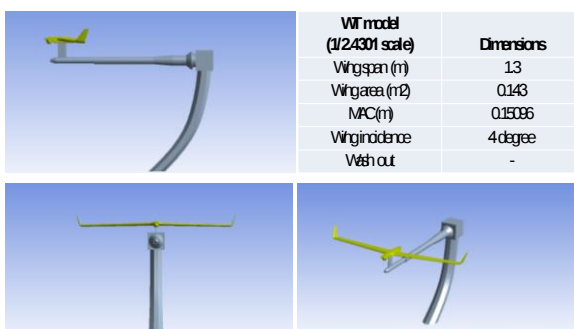
รูปที่ 4 รูปร่างและขนาดหุ่นจำลองอากาศยานไร้คนขับขนาดเล็กแบบไร้หาง เมื่อติดตั้งกับแท่นยึดและเครื่องมือวัดแรง
