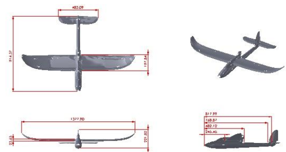
รูปที่ 4 การหาค่ามิติต่าง ๆ จากหุ่นจำลองของอากาศยานด้วยโปรแกรม CAD [6]
