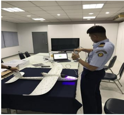
รูปที่ 2 การกราดภาพด้วยเครื่องกราดภาพสามมิติ [6]
