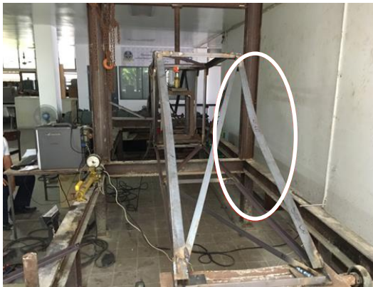
รูปที่ 4 องค์อาคารที่เกิดการวิบัติของสะพานเหล็ก แบบที่ 1 หลังการทดสอบ
