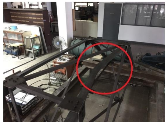
รูปที่ 8 องค์อาคารที่เกิดการวิบัติของสะพานเหล็ก แบบที่ 3 หลังการทดสอบ
