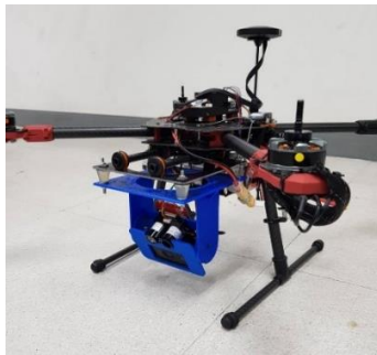
รูปที่ 7 แสดงการติดตั้งอุปกรณ์การภาพบนอากาศยานไร้คนขับแบบ 4 ใบพัด
