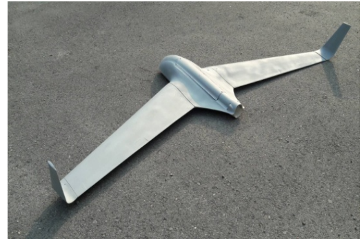
รูปที่ 2 ต้นแบบอากาศยานไร้คนขับแบบไร้หางที่สร้างด้วยวัสดุคอมโพสิต
