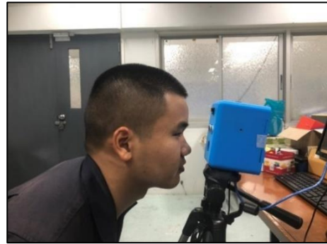
รูปที่ 13 ภาพผู้เข้ารับการทดสอบวัดอุณหภูมิแบบอินฟราเรด ในระยะ 5-15 เซนติเมตร
