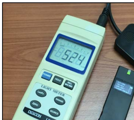
รูปที่ 7 ผลการวัดค่าสว่างความอาคารเรียนรวมและปฏิบัติการ
