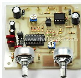
รูปที่ 9 วงจรผลิตความถี่ 0.5 เฮิรตซ์-100 กิโลเฮิรตซ์ และแผ่นผังวงจร
