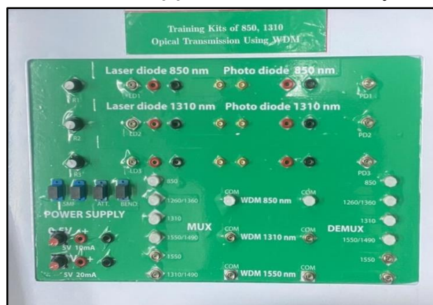
รูปที่ 6 ชุดสาธิตการส่งสัญญาณแสงโดยวิธีการมัลติเพล็กซ์แบบแบ่งความยาวคลื่น 850 นาโนเมตรและ 1,310 นาโนเมตร
