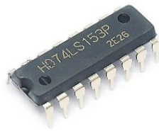
รูปที่ 7 วงจรรวมเบอร์ 74153 และ Pin Arrangement (MUX)
