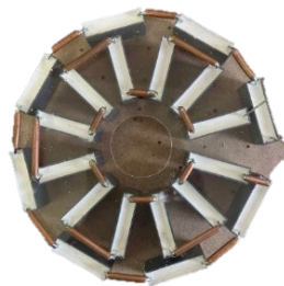
รูปที่ 9 การวางตัวเก็บประจุภาคแรงดันสูงในแต่ละชั้น
