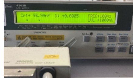
รูปที่ 10 ค่าความจุไฟฟ้าด้านแรงสูงและค่าความจุไฟฟ้าด้านแรงต่ำที่วัดได้จาก LCR Meter Agilent 4263B
