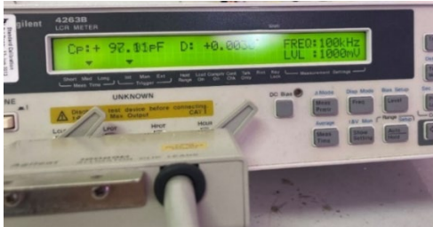
รูปที่ 10 ค่าความจุไฟฟ้าด้านแรงสูงและค่าความจุไฟฟ้าด้านแรงต่ำที่วัดได้จาก LCR Meter Agilent 4263B
