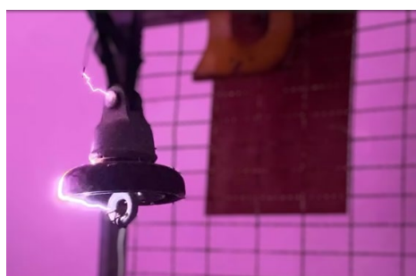
รูปที่ 15 การทดสอบโวลเตจดีไวเดอร์ในการทดสอบลูกถ้วยด้วยหม้อแปลงทดสอบวัดขณะมีโหลด
