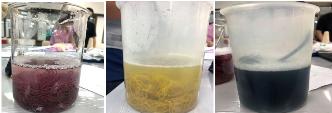
รูปที่ 5 กระบวนการผลิตสีธรรมชาติบนเส้นด้ายบัวหลวง
