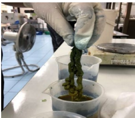
รูปที่ 4 การย้อมสีน้ำเงินด้วยอัตราส่วนและสภาวะในกระบวนการย้อมสีน้ำเงินจากคราม
