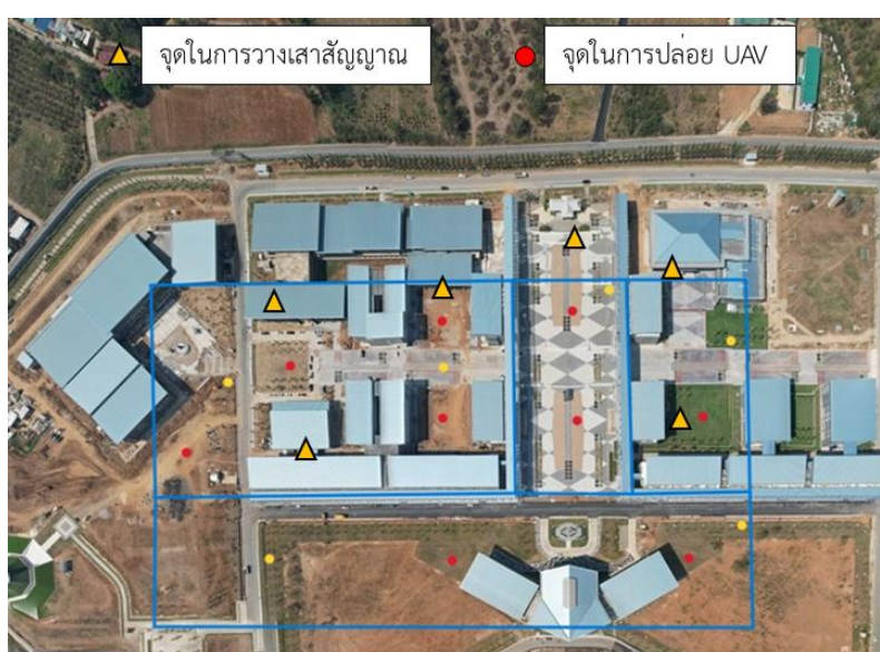
รูปที่ 4 แสดงตำแหน่งการวางเสาสัญญาณเพื่อให้ครอบคลุมระยะการบินของอากาศยานไร้คนขับ
