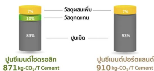
รูปที่ 3 เปรียบเทียบการลดการปล่อยก๊าซคาร์บอนไดออกไซด์ กรณีใช้วัสดุทดแทนที่ร้อยละ 10 [26]
