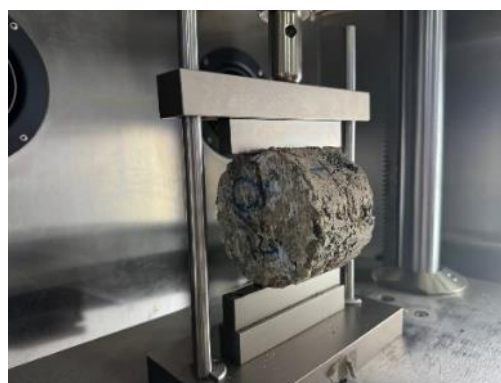
(ข) ทดสอบความต้านทานแรงดึงทางอ้อม
