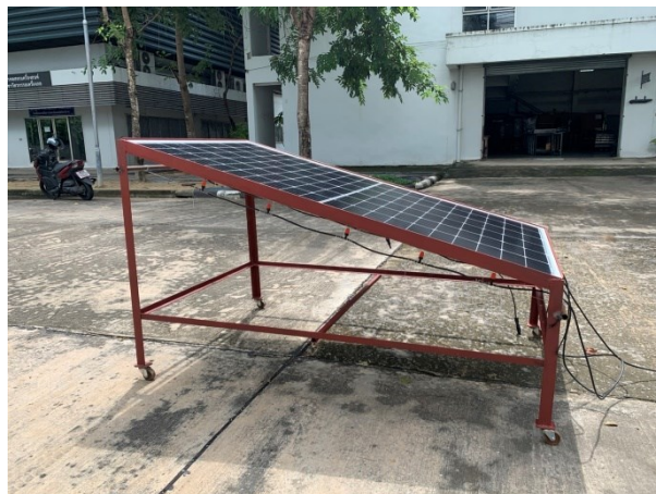
รูปที่ 3 แผงเซลล์แสงอาทิตย์ที่มีระบบระบายความร้อนด้วยน้ำ
