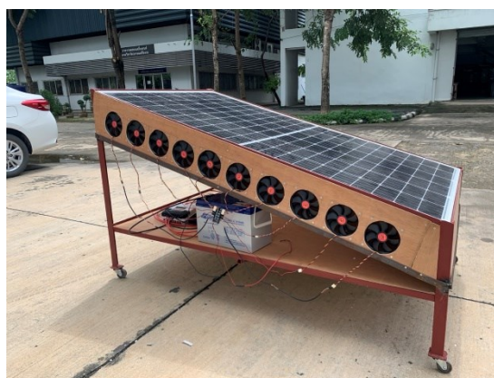
รูปที่ 2 แผงเซลล์แสงอาทิตย์แบบมีระบบระบายความร้อนด้วยอากาศ
