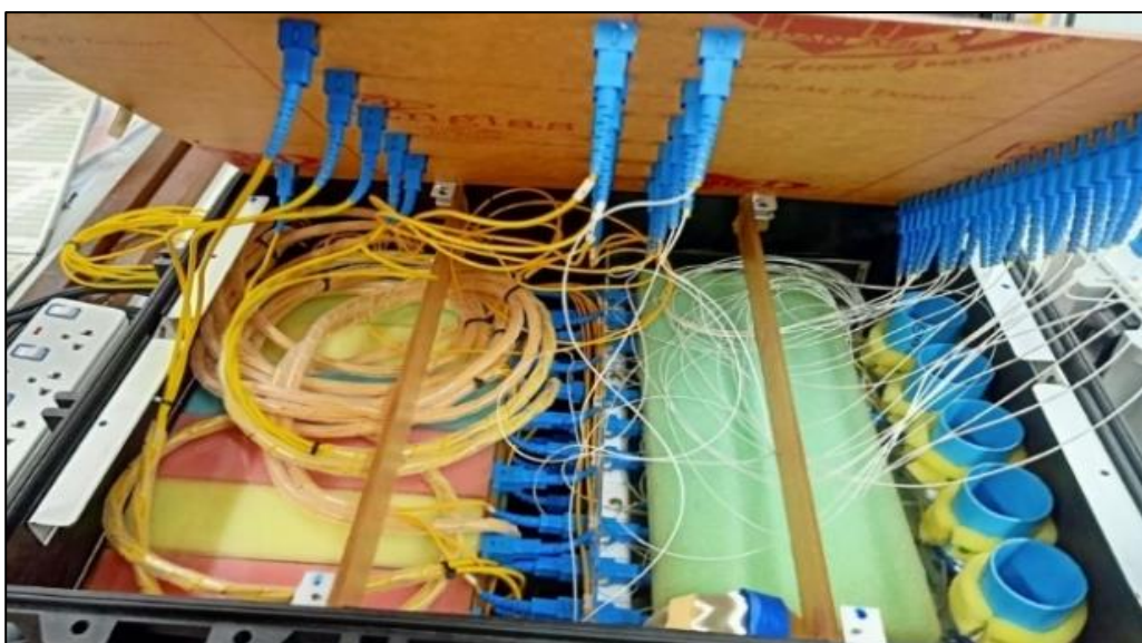
รูปที่ 11 การออกแบบจุดเชื่อมต่อของเส้นใยแก้วนำแสงภายในชุดสาธิต
