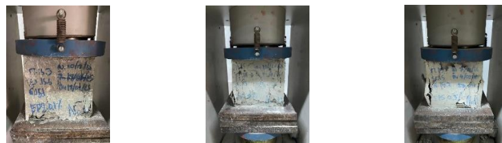
คอนกรีตที่ผสม ESP 0.1% คอนกรีตที่ผสม ESP 0.2% คอนกรีตที่ผสม ESP 0.3%
