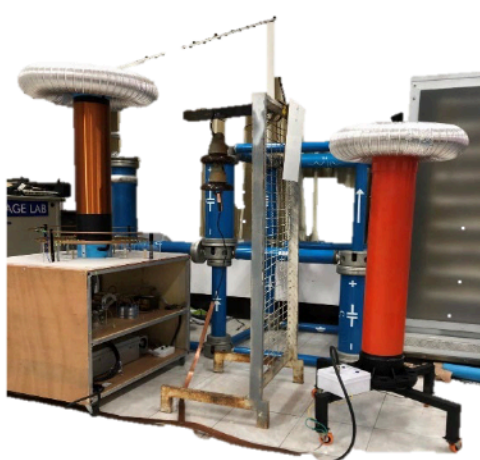
รูปที่ 15 การทดสอบโวลเตจดีไวเดอร์ในการทดสอบลูกถ้วยด้วยหม้อแปลงทดสอบวัดขณะมีโหลด
