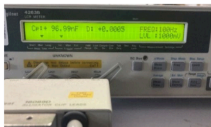
รูปที่ 10 ค่าความจุไฟฟ้าด้านแรงสูงและค่าความจุไฟฟ้าด้านแรงต่ำที่วัดได้จาก LCR Meter Agilent 4263B
