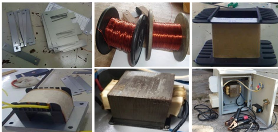
รูปที่ 3 การสร้างหม้อแปลงไฟฟ้าแรงดันสูง
