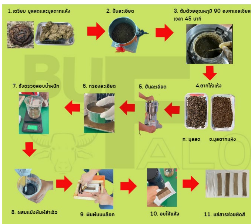
รูปที่ 1 กระบวนการสกัดสีพิมพ์ธรรมชาติจากมูลกระบือ
