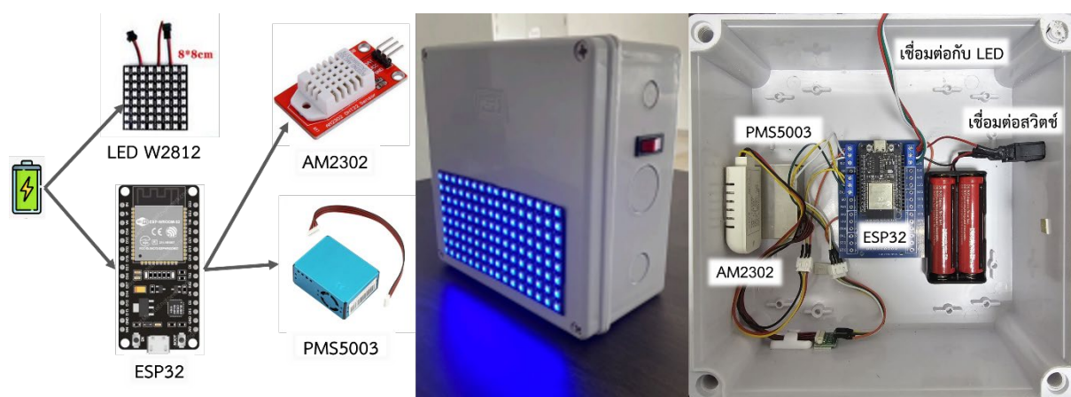
รูปที่ 1 (ซ้าย) ผังวงจร (กลาง) อุปกรณ์ต้นแบบ (ขวา) วงจรภายใน
