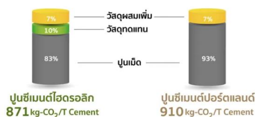
รูปที่ 3 เปรียบเทียบการลดการปล่อยก๊าซคาร์บอนไดออกไซด์ กรณีใช้วัสดุทดแทนที่ร้อยละ 10 [26]
