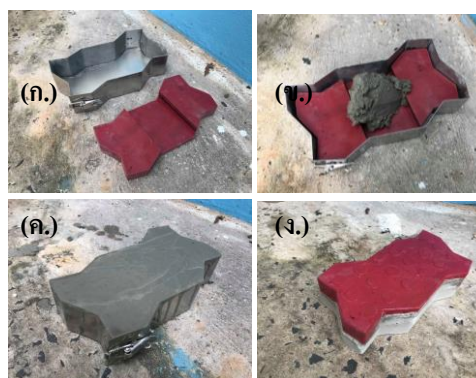
รูปที่ 9 การเตรียมบล็อกยางปูพื้น (ก.) แม่พิมพ์และแผ่นยางบล็อกยางปูพื้น (ข.-ค.) การเทปูนซีเมนต์ลงบนแม่พิมพ์ที่มีแผ่นยางบล็อกยางปูพื้น (ง.) บล็อกยางปูพื้น
