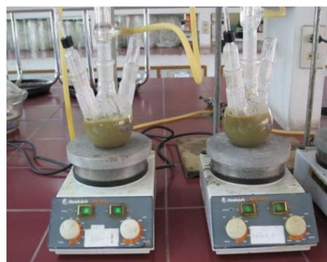
รูปที่ 1 การจัดอุปกรณ์สำหรับการเตรียมตัวดูดซับ
