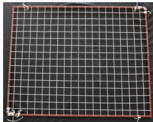
รูปที่ 6 โครงตาข่ายซึ่งจุดตัดของตาข่ายจะเป็นตำแหน่ง (x_0, y_0, z_0) ใด ๆ ที่ใช้วัดความเข้มรังสี
