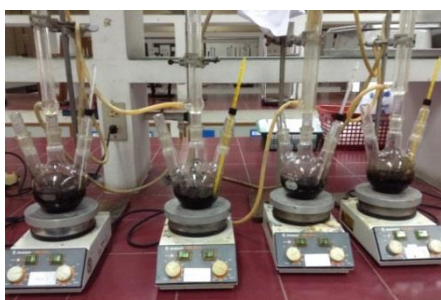
รูปที่ 1 ชุดรีฟลักซ์สำหรับเตรียมไบมันสำปะหลังคัดแปร
