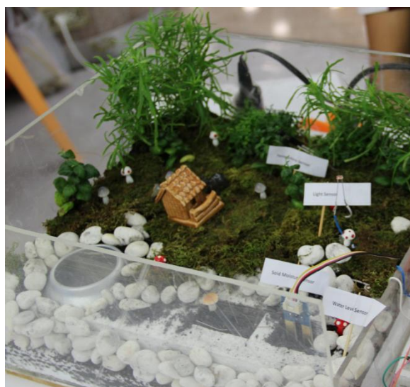
รูปที่ 2 แปลงจำลองสภาพแวดล้อมเพื่อการทดสอบพร้อมติดตั้งระบบตรวจวัดสภาพแวดล้อม
