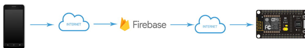
ภาพที่1 หลักการทำงานของชุดควบคุมเครื่องใช้ไฟฟ้าผ่านแอปพลิเคชัน
