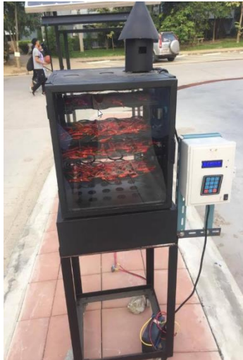
ภาพที่ 2 ระบบควบคุมการอบแห้งด้วยเจลกักเก็บความร้อน
