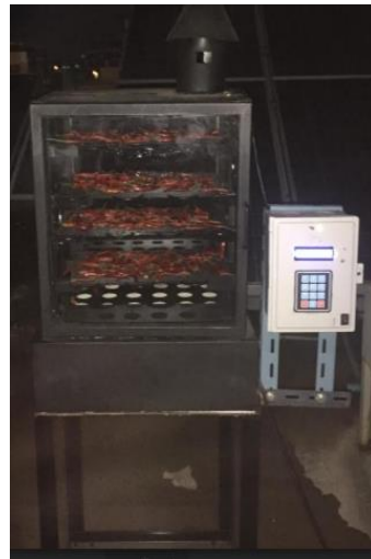
ภาพที่ 2 ระบบควบคุมการอบแห้งด้วยเจลกักเก็บความร้อน
