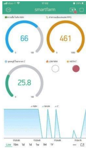
ภาพที่ 4 ผลการแสดงผลอุณหภูมิความชื้นและความชื้นในดินบนอุปกรณ์เคลื่อนที่
