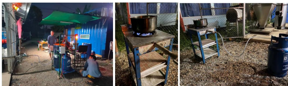
ภาพที่ 4 การทดสอบหาค่าความร้อน
