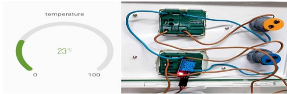
ภาพที่ 12 แสดงการทำงานด้วยเซนเซอร์ DHT11
