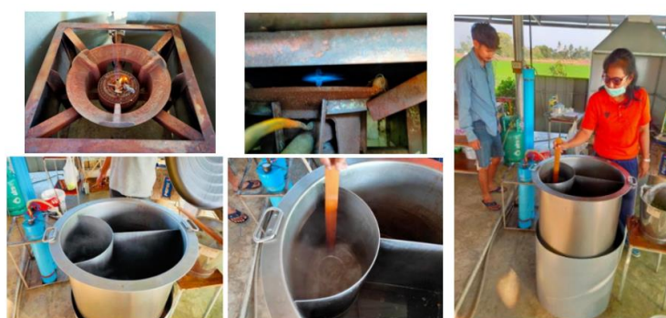
ภาพที่ 5 การทดสอบการใช้แก๊สชีวมวลความจุ 50 ลิตร ต้มน้ำก๋วยเตี๋ยว
