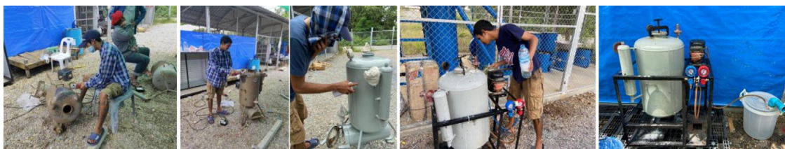
ภาพที่ 2 โครงสร้างแก๊สชีวมวลอัดถังที่เหมาะสมกับธุรกิจร้านก๋วยเตี๋ยวขนาดเล็ก
