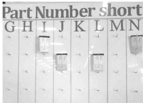
ภาพที่ 3 การนำบัตรคัมบังมาแขวนที่บอร์ด เพื่อรอให้พนักงานเติมนำวัสดุที่ขาดมาเติมตามรหัส
