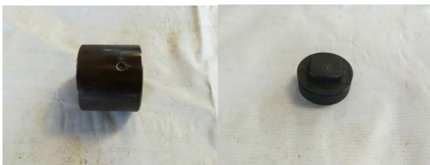
ภาพที่ 2 ตัวอย่างของบูท (ซ้าย) และตัวอย่างของฝาปิดถังน้ำมัน (ขวา)
