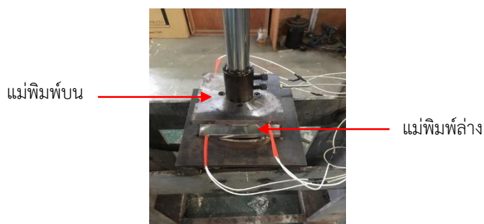
ภาพที่ 1 การติดตั้งฮีตเตอร์สำหรับแม่พิมพ์บนและแม่พิมพ์ล่าง
