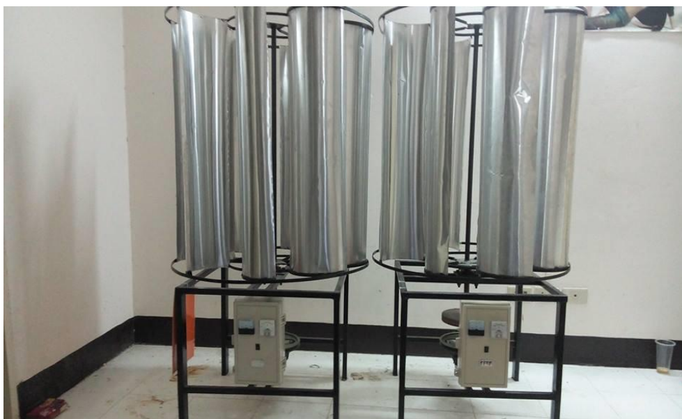
ภาพที่ 2 กังหันลมผลิตไฟฟ้าแนวแกนตั้งที่มีล้อช่วยแรงสะสมพลังงาน(ขวา) และไม่มีล้อช่วยแรงสะสมพลังงาน(ซ้าย)
