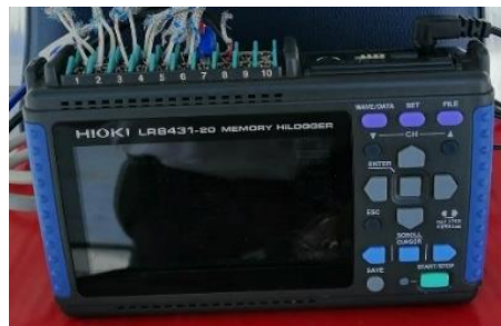
(ค) เครื่องบันทึกข้อมูลอัตโนมัติ ยี่ห้อ HIOKI รุ่น LR8431-20 ภาพที่ 3 อุปกรณ์และเครื่องมือที่ใช้ในการดำเนินการทดลอง
