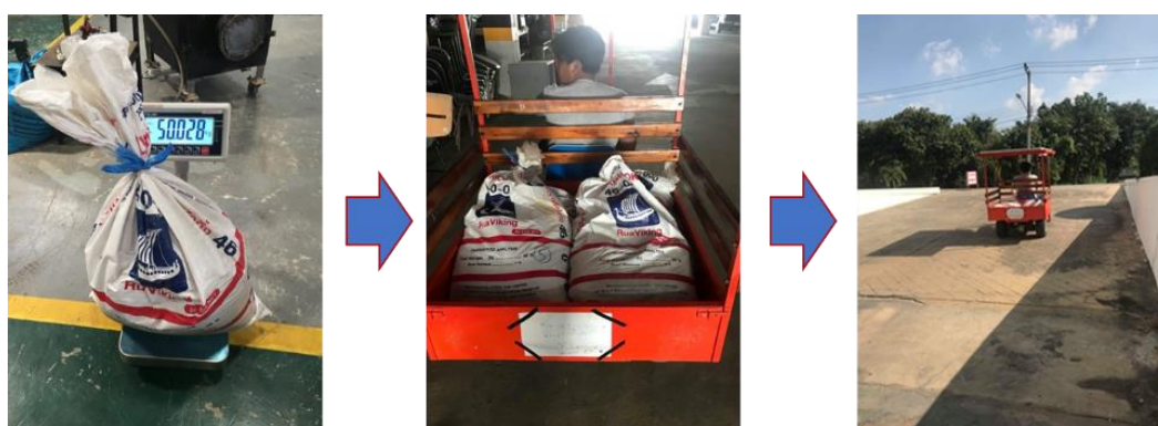
ภาพที่ 4 การทดลองขับเคลื่อนรถสามล้อไฟฟ้าที่ความชันมุม 6 และ 9 องศา
