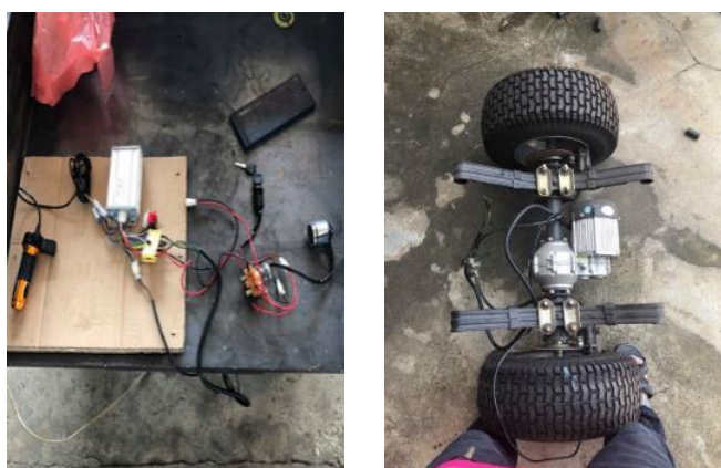
ภาพที่ 2 ชุดควบคุม และระบบส่งกำลังจากมอเตอร์ไฟฟ้ากระแสตรง
