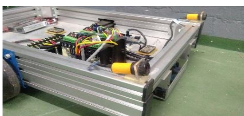
ภาพที่ 12 ตัวรถที่ใช้อลูมิเนียมโปรไฟล์เป็นโครงสร้าง (พลีษฐ์ และคณะ, 2561)
