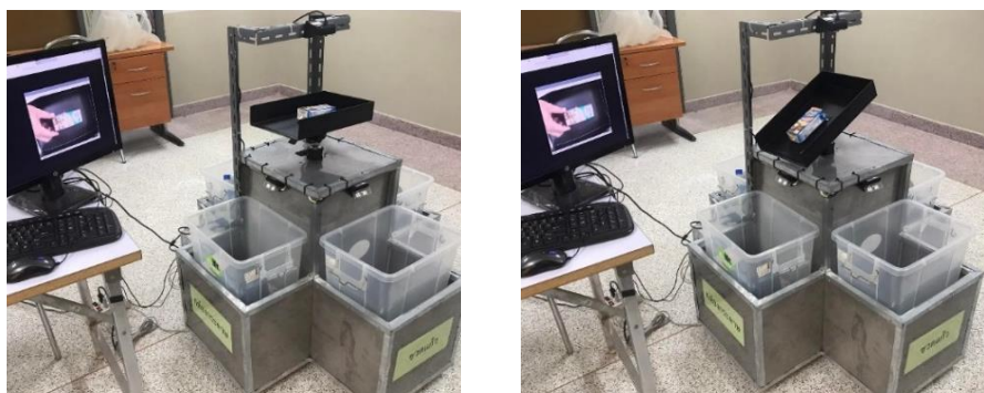
ภาพที่ 6 การทดสอบการหมุนของของสแตมป์มอเตอร์และการเทของเซอร์โวมอเตอร์
