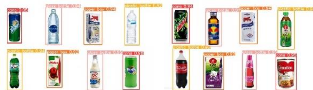
ภาพที่ 4 ตัวอย่างผลการคัดแยกภาพจากโมเดลที่ฝึกสอน
