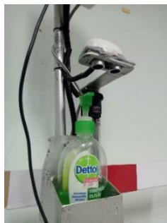
(ก) ยืนทดสอบหน้าชุดคัดกรอง (ข) จุดติดตั้งอัลตราโซนิกจ่ายเจลล้างมือ (ค) แขนกั้นยกเข้าพื้นที่ ภาพที่ 6 การติดตั้งเซ็นเซอร์ตรวจจับฝ่ามือและแขนกั้นยก
