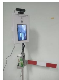
(ก) ยืนทดสอบหน้าชุดคัดกรอง (ข) จุดติดตั้งอัลตราโซนิกจ่ายเจลล้างมือ (ค) แขนกั้นยกเข้าพื้นที่ ภาพที่ 6 การติดตั้งเซ็นเซอร์ตรวจจับฝ่ามือและแขนกั้นยก
