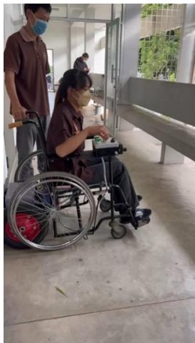
(ก) การทดสอบสิ่งกีดขวาง (ข) การทดสอบบนทางลาดชัน (ค) การทดสอบหารัศมีวงเลี้ยว ภาพที่ 10 การทดสอบการใช้งานของรถเข็นไฟฟ้า
