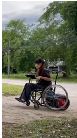
(ก) การทดสอบสิ่งกีดขวาง (ข) การทดสอบบนทางลาดชัน (ค) การทดสอบหารัศมีวงเลี้ยว ภาพที่ 10 การทดสอบการใช้งานของรถเข็นไฟฟ้า
